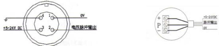
(1) 采用航空插头的放大器的接线
